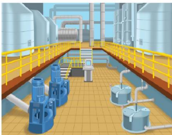
sok jest podgrzewany w dużych pojemnikach przypominających beczki, następnie syrop wirowany jest w specjalnych wirówkach, na ściankach wirówki osadza się biały kryształ
